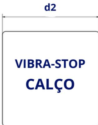
**Aplicações:** Suporte para equipamentos sem furação, calço ou apoio para tubulações, calço para os vibra-stop da linha tradicional e suporte para equipamentos sem fixação.
